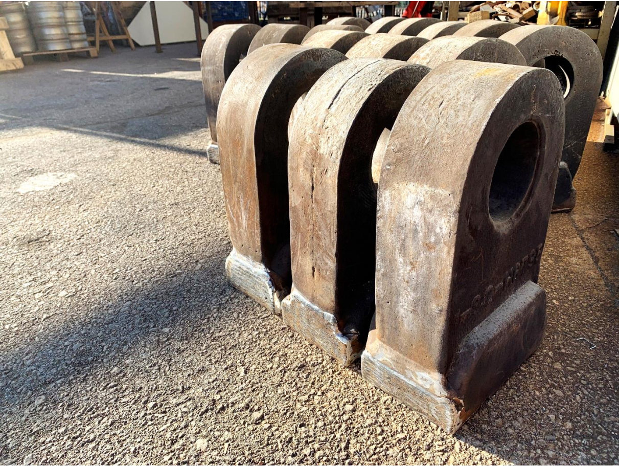
Navarivanje istrošenja čekića drobilice
