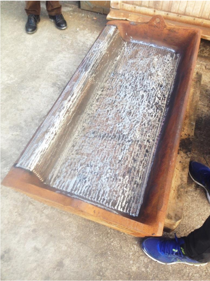
Robotizirano navarivanje oštećenja kade za lavu
